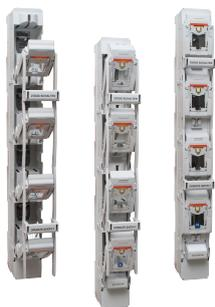
MULTIVERT® NH 4P ist die erste vertikale 4-polig schaltbare (3P + N) NH-Sicherungs-Lastschaltleiste für das 185mm Sammelschienensystem mit einer Gesamtbreite von 100mm.
